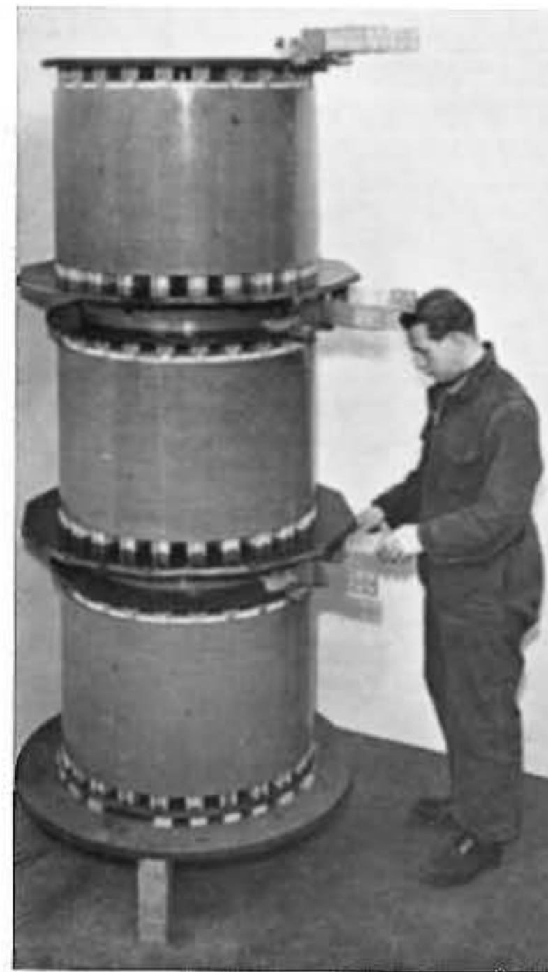
Afb. 10. Driefazeeenheid van een kortsluitstroom-begrenzingsmoorspoel, waarin rechthoekige kabel is toegepast.
