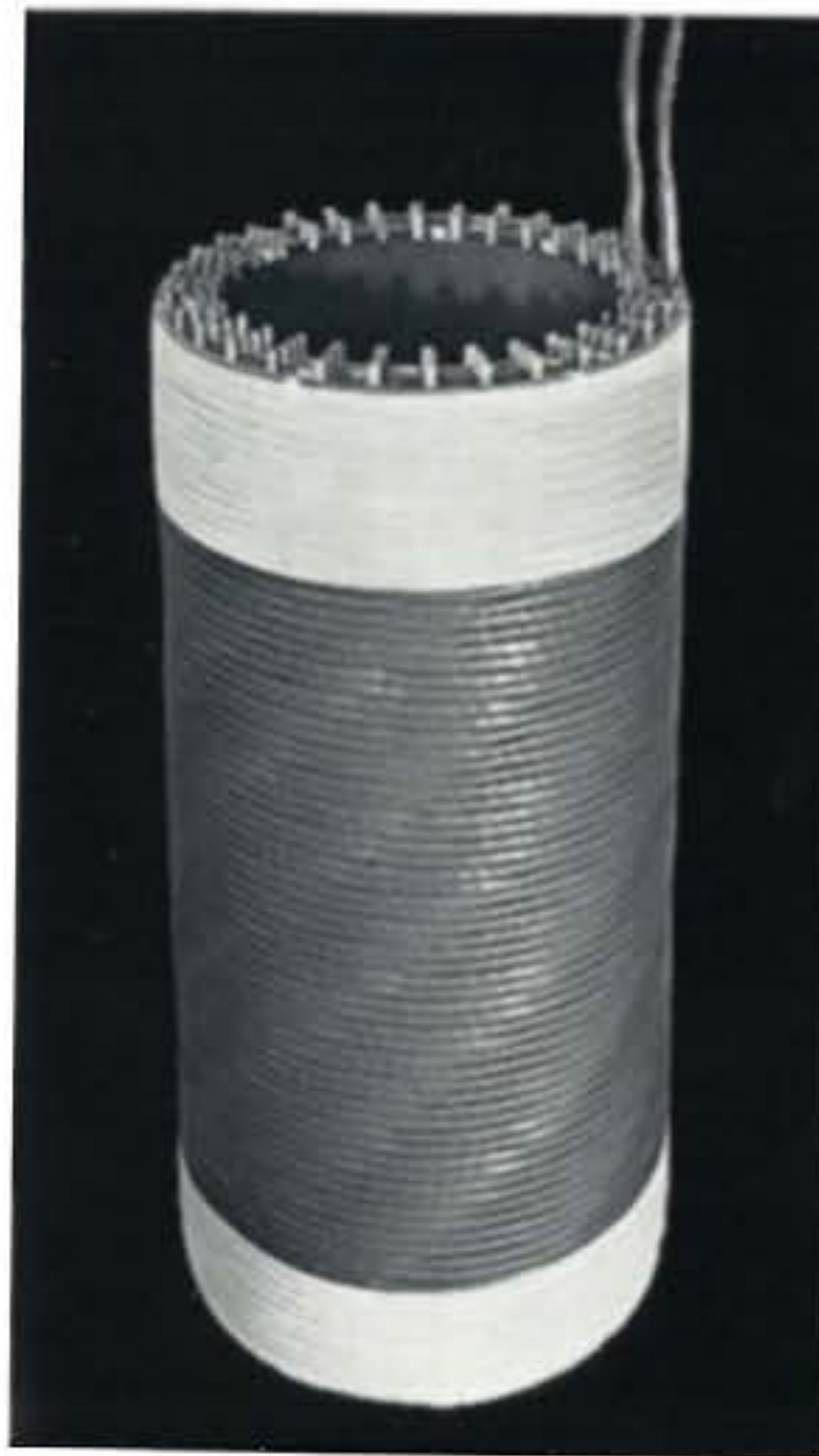
Afb. 6. Lagenwikkeling voor een middelgrote transformator, gewikkeld van rechthoekige kabel.
